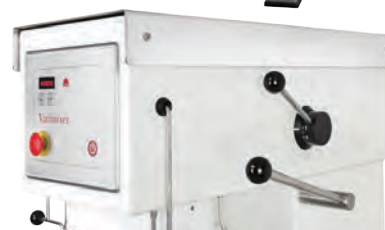
VL-1 Régulation de vitesse manuelle et abaissement de cuve
